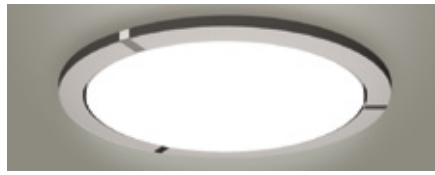
Đèn trần LED loại trung, khung viền bạc 19W AC220-240V, Ø500mm/ H96mm/ 1,25 Kg, CRI: Ra85 HH-LA152619 (Ánh sáng vàng 2700K - 72,6lm/W) 1380lm/19W HH-LA152819 (Ánh sáng trắng 6500K - 84,2lm/W) 1600lm/19W
