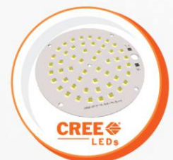
Cree SMD 3030: Được lắp đặt trong Đèn nhà xưởng, Đèn đường
