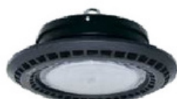
Hiệu suất quang 150lm/W. Có thể lập trình time dimming, Constant lumen T a : -20°C ~ 45°C. Phù hợp tiêu chuẩn EMC, QCVN19
